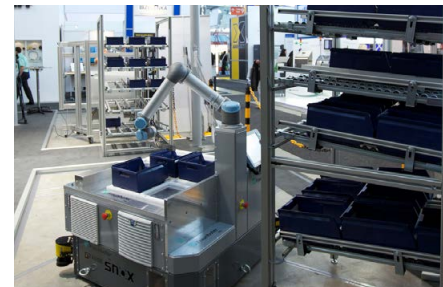
Nachversorgung mit Kleinladungsträgern (KLT) im Produktionslager mit einem mobilen Manipulator.
